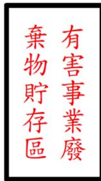
圖 3、貯存區設置白底、紅字、黑框之警告標示圖例
